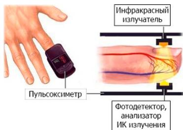
Рис. 2.7. Структура пульсоксиметра
